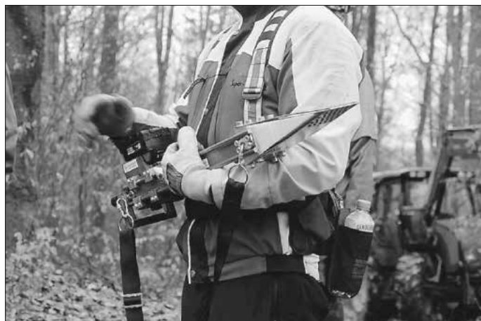
Mit dem ferngesteuerten Fällkeil kann Schadholz sicherer gefällt werden. Nur wer an der Schulung teilgenommen hat, kann später das neue Gerät von der FBG ausleihen.
